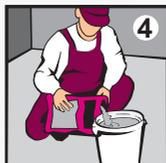
**4** Для подготовки раствора залейте водопроводную воду комнатной температуры в чистую ёмкость из расчёта 4,5 - 5,5 л воды на 1 мешок (25кг).
