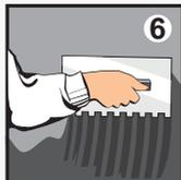
**6** Нанесите клей зубчатым шпателем. Размер зубьев зависит от размера и веса укладываемой плитки. Уложите плитку в течение 20 минут после нанесения клея на основание. Выровняйте плитку в течение 15 минут.
